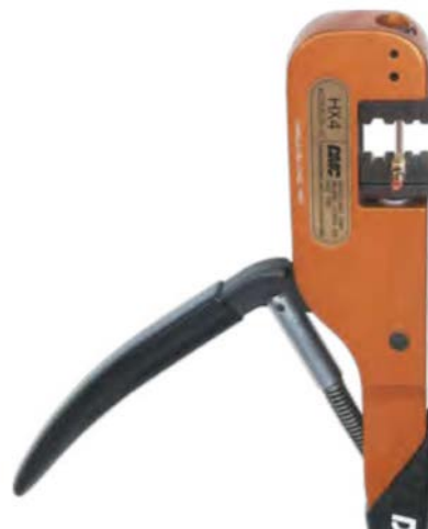
Crimping the outer conductor with hand cimp tool M22520/5-01. Crimpfung des Außenleiters mit der Handcrimpzange M22520/5-01.
