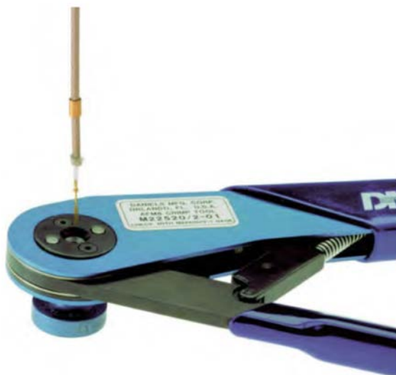
Crimping the inner conductor with hand cimp tool M22520/2-01. Crimpfung des Innenleiters mit der Handcrimpzange M22520/2-01.
